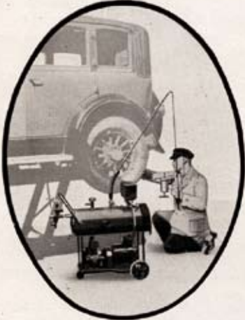
Abb. 9. Beim Abschmieren mit autom. Fettpistole.
