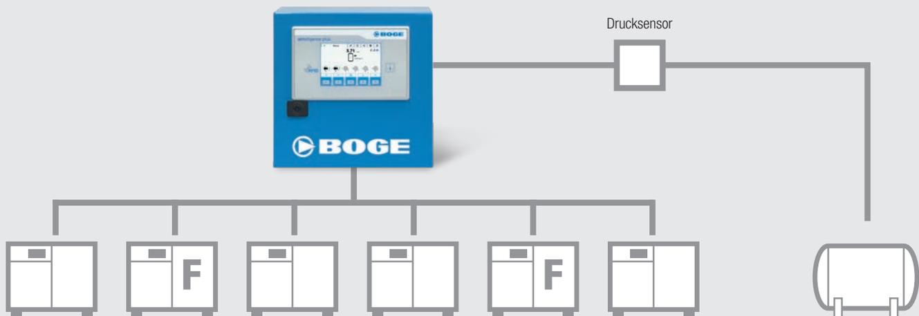
**Bis zu 6 starre oder frequenzgeregelt Kompressoren verbrauchsbhängig steuern:**
