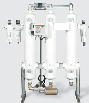
Überwachung des Drucktaupunktes und stellt so die belastungsabhängige Betriebsweise der Atemlufttrockner sicher. So lässt sich der Energiebedarf für die Regeneration der Trockenmittelbetten um bis zu 50 % reduzieren.
