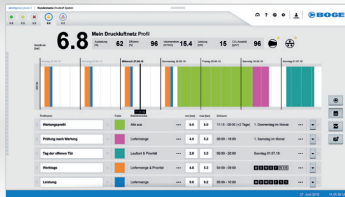
Ejemplo de perfiles de aire comprimido
