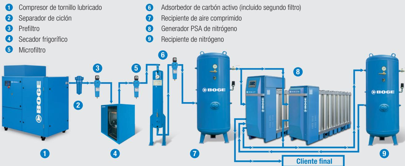
Todo de un único proveedor. BOGE es un proveedor de sistemas capaz de crear un sistema global óptimamente sintonizado formado por compresor, filtración, generador, secador frigorífico, adsorbedor de carbón activo, depósito, generador PSA de nitrógeno y otros componentes de preparación. El resultado: más seguridad, más independencia y máxima eficiencia.
